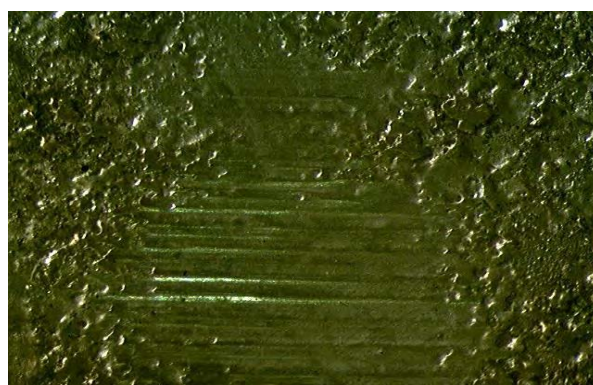
Рис.2. Доріжка тертя зразка після випробування на абразивний знос
