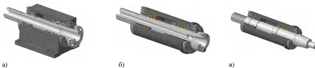
Рис.2- Варіанти параметричних 3D-моделей КШВ: а) токарних верстатів; б) фрезерних верстатів; в) шліфувальних верстатів
